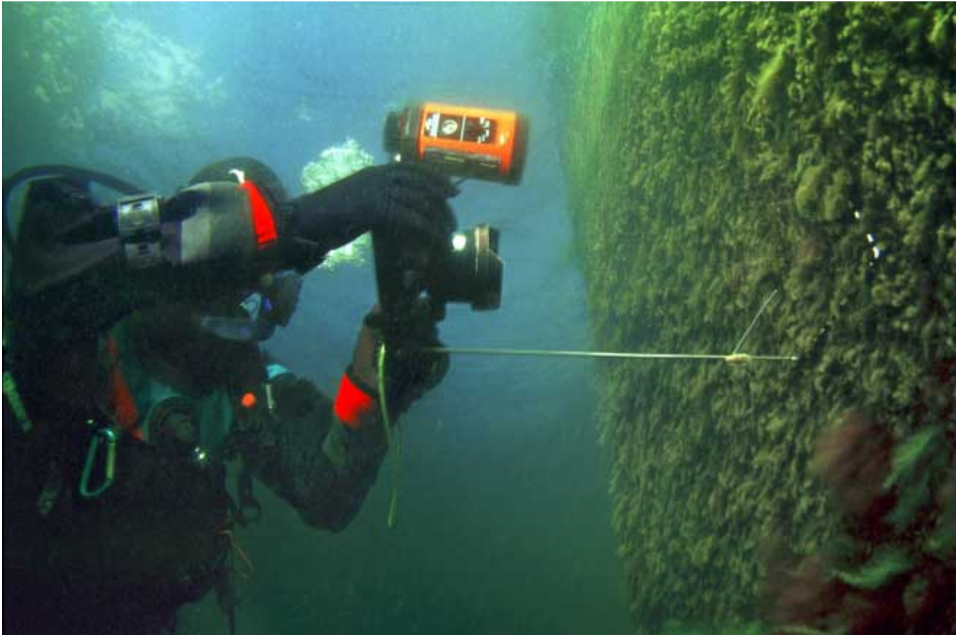
Kamerans närbildsram är avsiktligt så liten, att den kommer med på bilden. Ramen är centimetergraderad och ger möjlighet att mäta storlek i bilderna.
